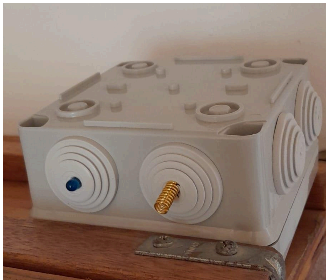
Protecció del mòdul de comunicacions per evitar el deteriorament per condicions adverses
