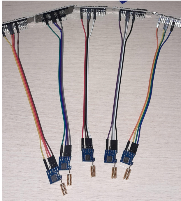
Antenes LoRa unides a plaques electròniques, on s'hi connecten els sensors
